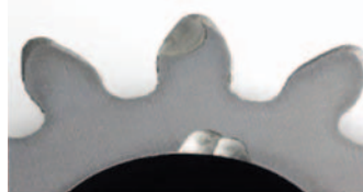
Príklad poškodenia strižníka pre presné strihanie – vyštiepenia na činnej časti
