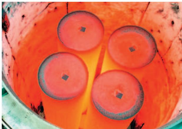
Kapsule naplnené práškom, v peci pri procese výroby ocele technológiou práškovej metalurgie, počas izostatického lisovania za tepla – HIP
