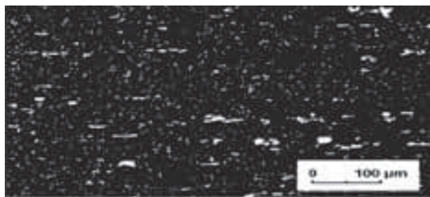
Mikroštruktúra ESU - elektrotroskovo pretavovanej ocele (BÖHLER K340 ISODUR)
