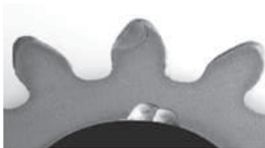
Príklad poškodenia strižníka pre presné strihanie – vyštípenia na činnej časti
