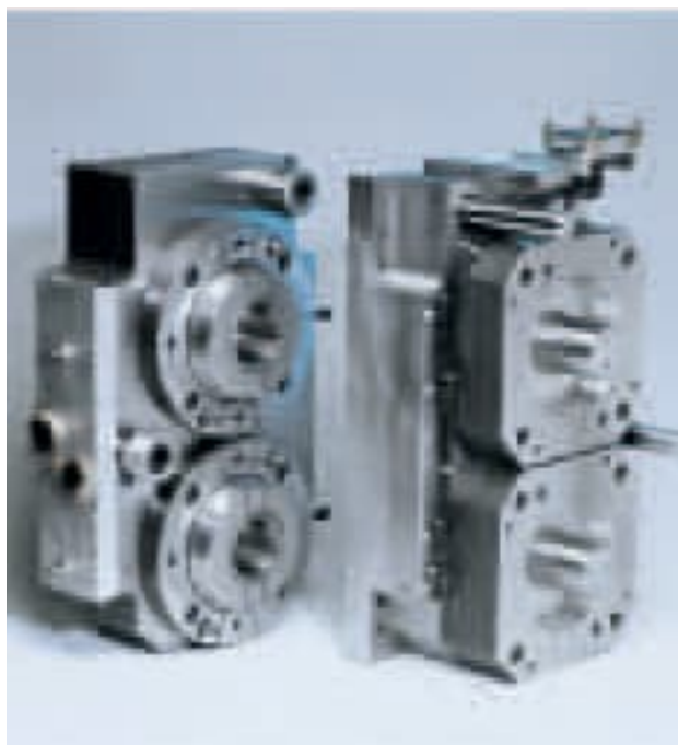
Forma na výrobu plastových pohárov
